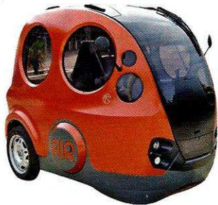
L'air comprimé à 300 bar stocké dans un réservoir de 300 L sous forme d'énergie mécanique pourrait produire une énergie mécanique comprise entre 27 MJ et 51 MJ pour un rendement de 100 %.
