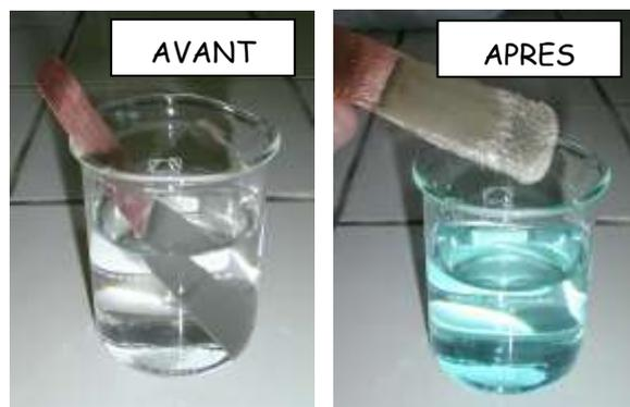
Données : couples oxydant/réducteur mis en jeu  $\text{Ag}^+_{(aq)} / \text{Ag}_{(s)}$  et  $\text{Cu}^{2+}_{(aq)} / \text{Cu}_{(s)}$ .
