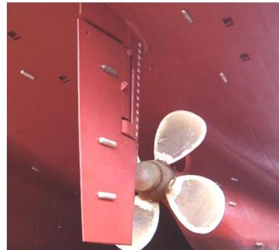
Pour protéger leurs navires essentiellement fabriqués en acier, les marins utilisent la technique de l'anode sacrificielle : ils plaquent sur la coque des navires des blocs d'un métal plus réducteur que le fer, qui subira la corrosion en lieu et place de la coque.
