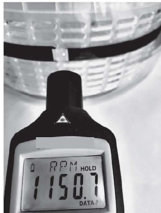
Figure 2. Tachymètre laser avec affichage de la vitesse de rotation en tours par minute
