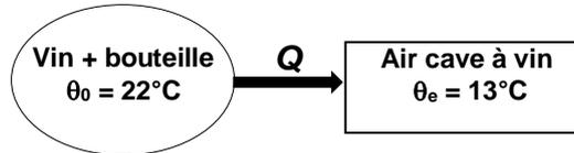
**Premier principe appliqué au système {vin + bouteille} :  $\Delta U = Q$  ( $Q < 0$  et  $W = 0$ ).**
