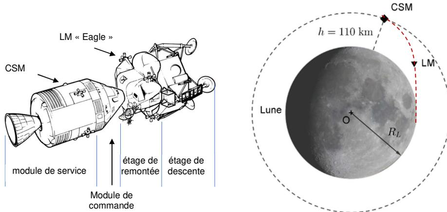
Le CSM est en orbite supposée circulaire autour de la Lune à une altitude de 110 km. Le LM « Eagle » descend vers la Lune. Il est alors à plus de 350 000 km de la Terre.
