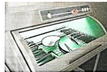
Lampe à UV-C servant à nettoyer du matériel médical.
