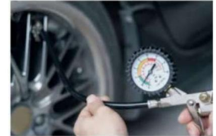
▲ Un mécanicien mesure la pression des pneumatiques d'un véhicule.
