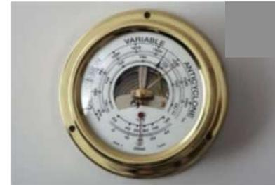
▲ Le baromètre anéroïde permet de mesurer la pression atmosphérique.
