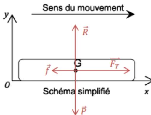
6. On se place à l'instant  $t = 0$  s. En appliquant le principe fondamental de la dynamique, montrer que si l'on néglige les forces de frottements, on peut écrire  $F_T = m \times a$ .
