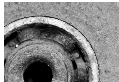
Roulement à billes oxydé
