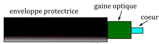
La fibre optique utilise le phénomène physique de la réflexion totale : la lumière est « piégée » dans le cœur et se propage en se réfléchissant à l'intérieur.
