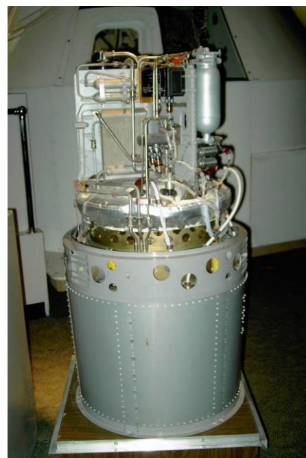
une unité de pile à combustible
