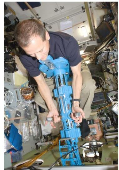
Sur la photo vous pouvez voir Tom Marshburn utilisant l'appareil de mesure de la masse.
